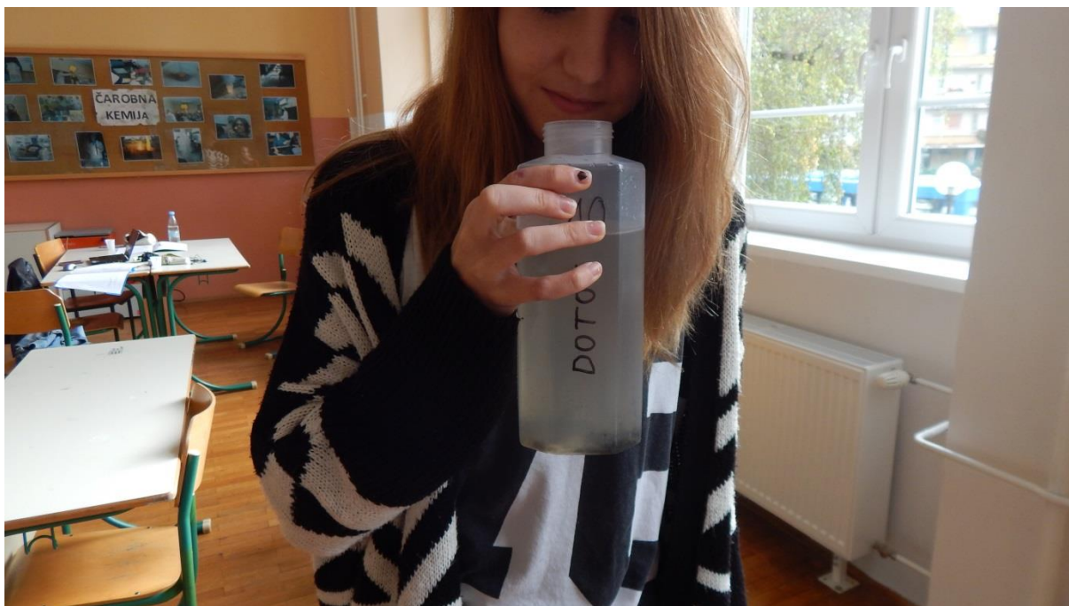
Slika 8: Določanje vonja vzorca vode kot primer fizikalne analize vode
